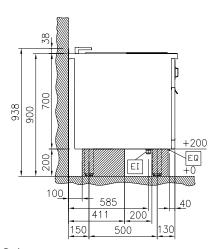
Drain ΕI Electrical inlet (power) EQ Equipotential screw
